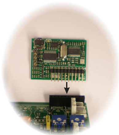
2. ábra: A Fiti vevőpanel csatlakoztatása a vezérlő egységhez
